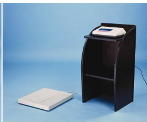
Desenho 2-17 Medidor electrónico de equilíbrio a um pé com os olhos fechados
